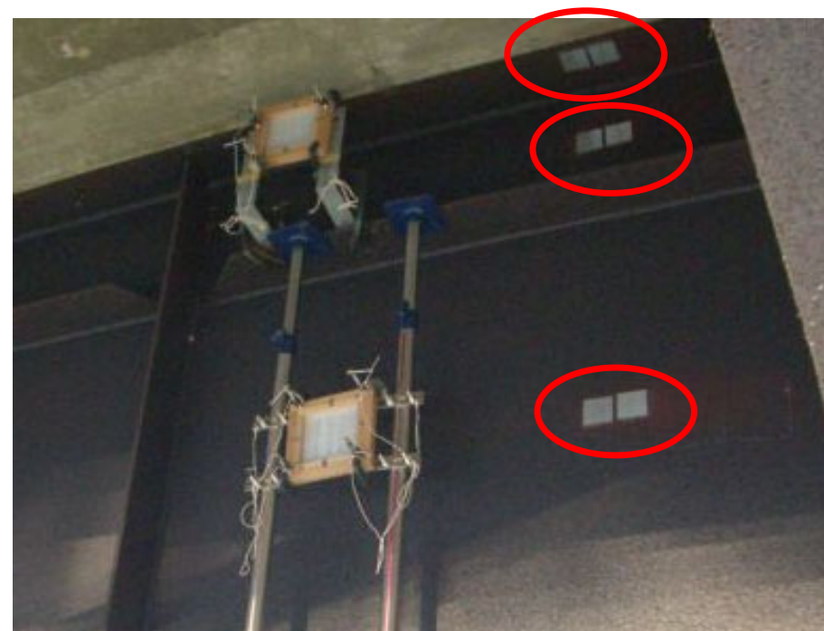
図-6 ワッペン試験片(縦横50mm, 板厚2～3mm) 短期曝露(数年)に適. 各部位の腐食評価に適
