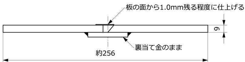
図3 放射線透過試験時の形状
